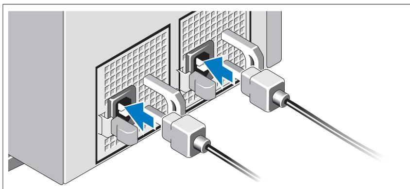
システムの電源ケーブルをシステムに接続し、モニターを使用する場合は、モニターの電源ケーブルをモニターに接続します。
