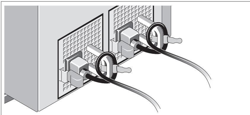
電源コード固定ブラケットを電源ユニットハンドルの右バンドに取り付けます。システムの電源ケーブルをループ状に曲げ（図を参照）、ブラケットのケーブル留め金に取り付けます。
