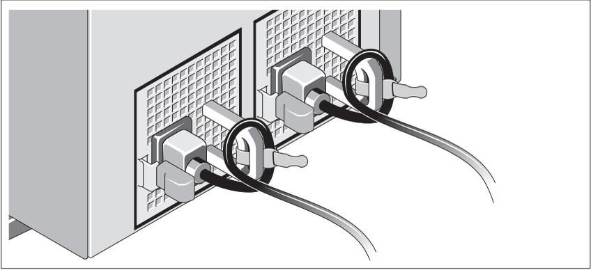
전원 공급 장치 핸들의 오른쪽 벤드에 있는 전원 코드 고정 브래킷을 연결합니다. 그림과 같이 시스템 전원 케이블을 고리 안으로 구부려서 브래킷의 케이블 걸쇠에 연결합니다.
