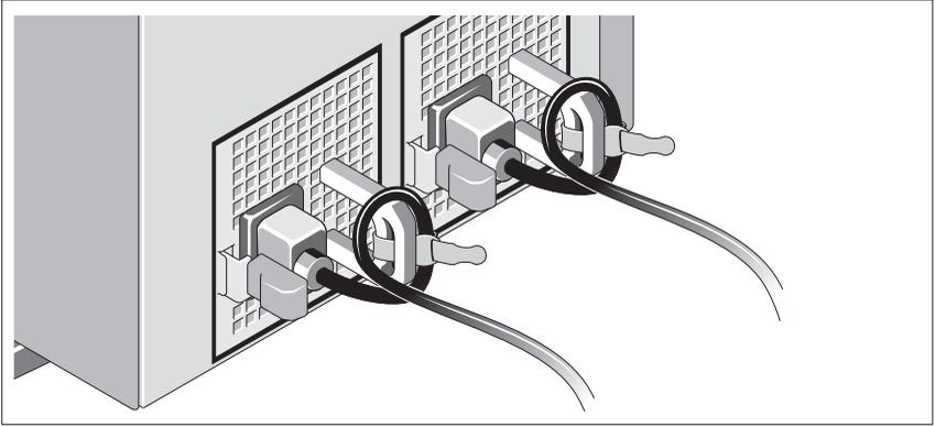
在电源设备手柄的右侧拐弯处上方连接电源线固定支架。如示意图所示，将系统电源电缆弯曲成环状，并连接至支架的电缆挂钩。
